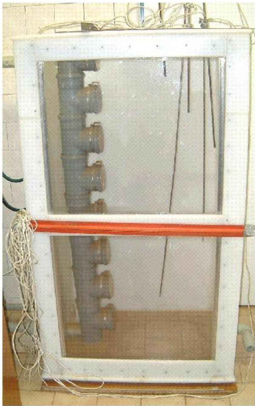
Obr. 7 a) Pokusné zařízení připravené na zkoušku stratifikace
