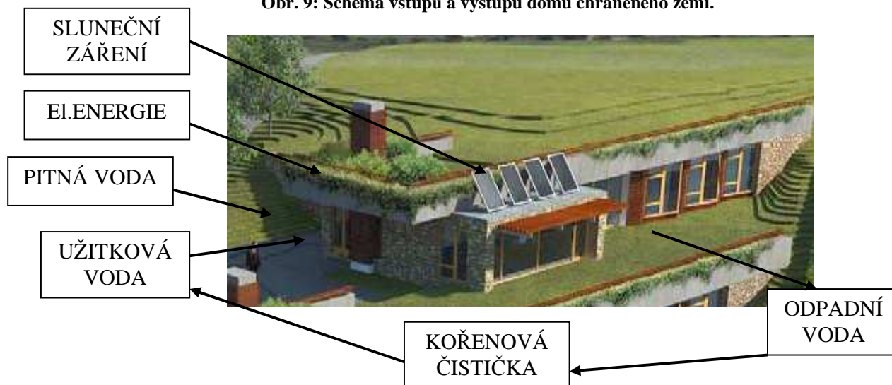
Obr. 9: Schéma vstupů a výstupu domu chráněného zemí.
